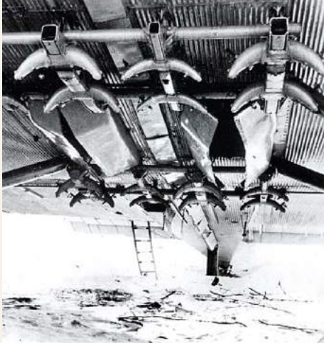
Zusätzliche Transportbehälter oder sperrige Lasten ließen sich an Außenträgern unter der Rumpfmittle befördern
