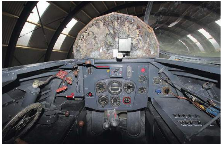
Das detailliert neu gestaltete Cockpit der Me 163 B
