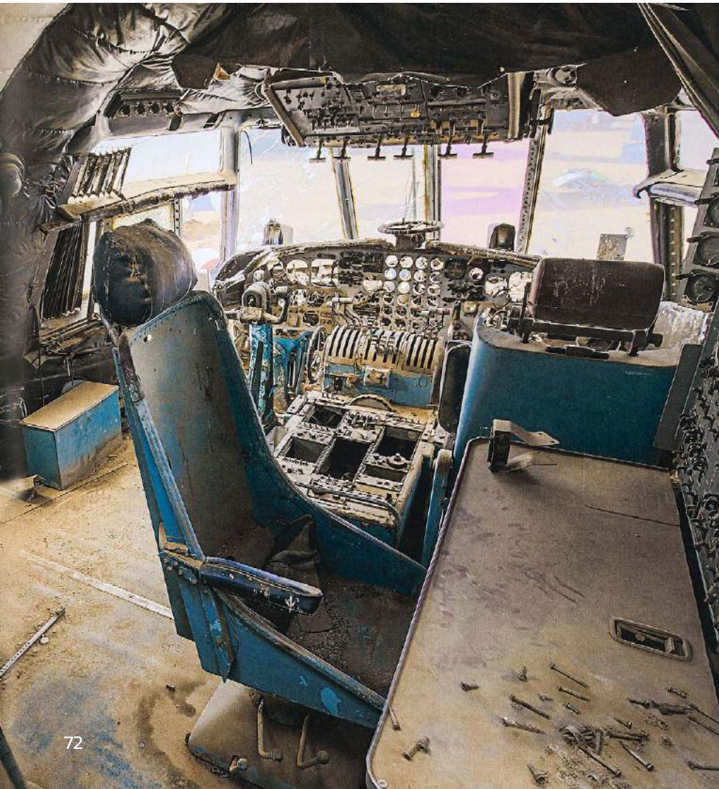
Cockpit einer der C-133. Die Besatzung bestand zumeist aus mindestens drei Mitgliedern. Vorne ist der Arbeitsplatz des Flugingenieurs zu sehen
