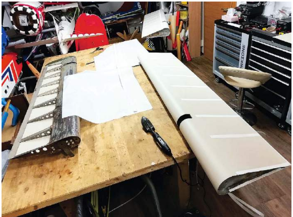
Bespannung von Querruder und Landeklappen
