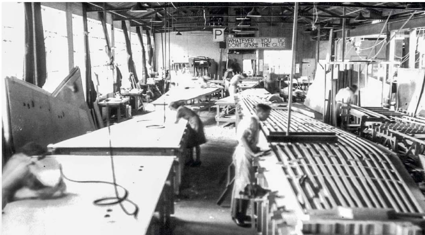
Fertigung von Tragflächen in der Möbelfabrik von WM Birch in High Wycombe, einem der vielen Zulieferbetriebe, die Komponenten für die Mosquito herstellen
