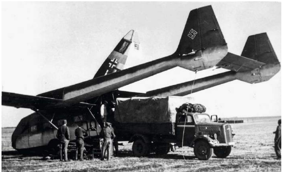
Bei der Gotha Go 242 konnte man das Rumpheck hochklappen. Für den Sondereinsatz gegen Scapa Flow wollte man im Frachtraum das »Sprengboot« transportieren
