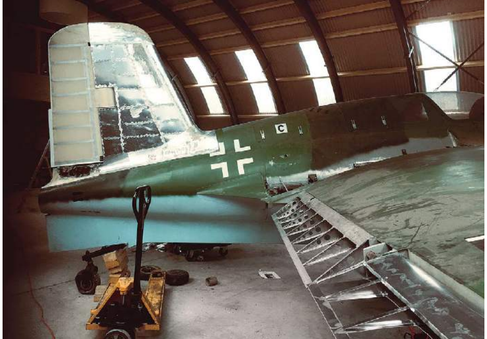
Das Seitenleitwerk ist montiert und das Ruder bespannt
