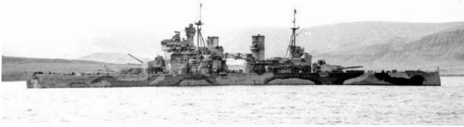
GETARNT: Der Anstrich von Prince of Wales von 1941 – im Original und mit der nachgezeichneten exakten Farbgebung – sollte den (See-)Gegner bei der Zielsuche und beim Einschießen irritieren
