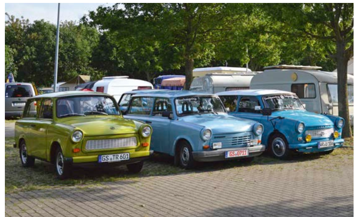
Der Trabant 1.1 (Mitte) eignet sich mit 40 PS etwas besser zum Zugfahrzeug als der 26 PS starke 601
