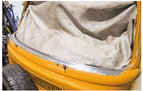
Neue Farbe. Nach dem Entrosten wurden die Löcher sauber verschweißt und der Fensterrahmen am Ende neu lackiert
