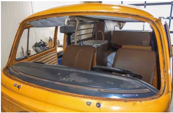
Klare Kante. Auch am US-Bus gab es Rost. die Fensterkante wurde komplett freigelegt
