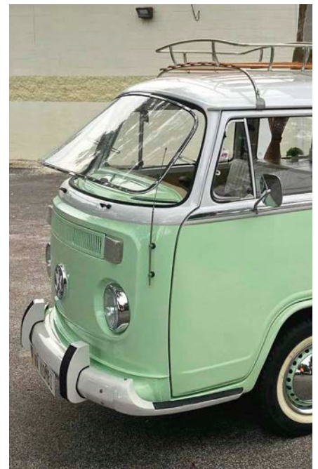
Heia Safari: Beim T1 Splitwindow gab es ausstellbare Frontscheiben, die Idee hat der Besitzer aufgegriffen
