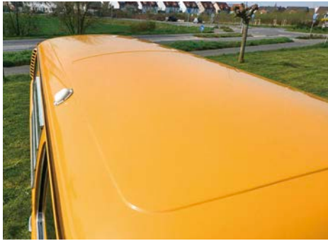
Noch ist der Dachausschnitt nur angedeutet. Für den Einbau des Aufsteldaches kommt die Blechschere zum Einsatz
