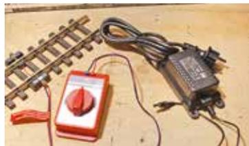
Drücken Sie nun die Kontaktanschlüsse am Fahrpult und stecken die farblich passenden Kabel ein. Schließen Sie anschließend das Fahrpult am Netzteil an.
