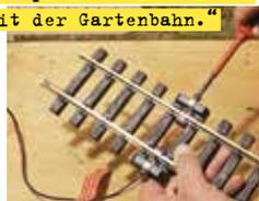
Die Gleiskontakte in die Gleisstränge einhängen, mit Schrauben festdrehen und mit dem Schraubenzieher fixieren.
