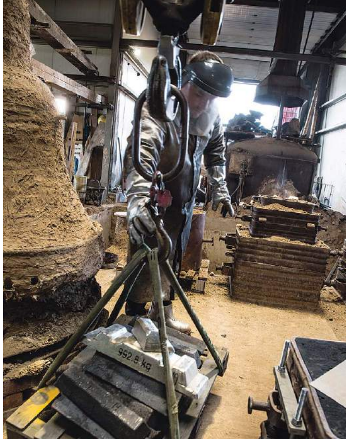
In der Giesserei Bachert werden die Glocken ausschließlich in Bronze gegossen, also 78 Teile Kupfer und 22 Teile Zinn.
