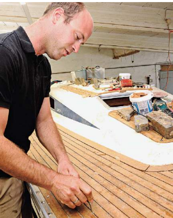
Viel Handarbeit: Timmerherm verlegt ein neues Teakdeck auf der Olsen 34, einem dänischen GFK-Klassiker der 1980er-Jahre.
