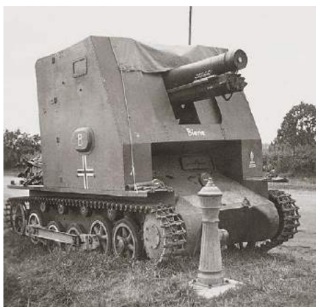
KLOBIG: Während des Frankreichfeldzuges stehen Selbstfahrlafetten für die schweren Infanteriegeschütze 33 zur Verfügung. Das Geschütz inklusive Lafette setzen die Ingenieure auf ein Panzer-I-Chassis
