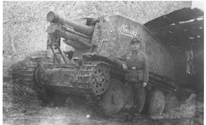
AN DER ITALIENFRONT: Auf dem Chassis des Panzerkampfwagens 38 aufgebaut, wird die Beweglichkeit der Regimentsartillerie deutlich verbessert. Die Grille bewährt sich ab 1942 an allen Fronten
