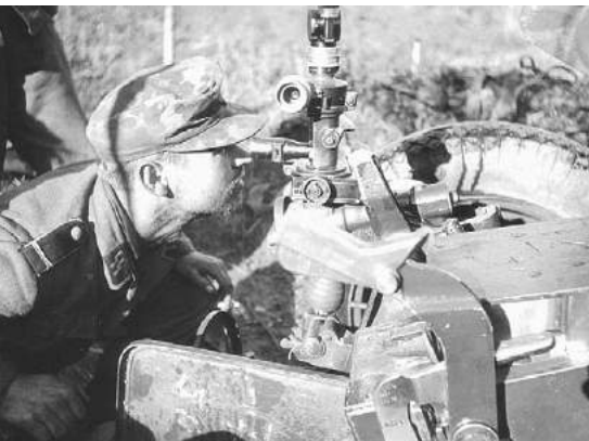
DEN GEGNER IM BLICK: Der Richtschütze dieses 7,5-cm-leichten-Infanteriegeschützes visiert das Ziel über das Zielfernrohr direkt an
