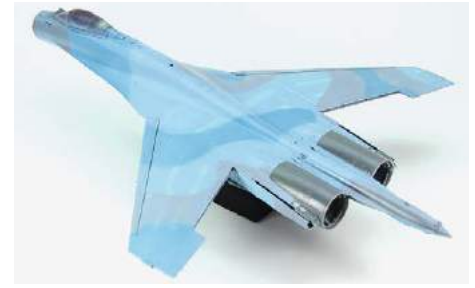
13 Alle drei Farbtöne sind lackiert, das Preshading sorgt schon jetzt für ein dezentes „Leben“ der Farbgebung
