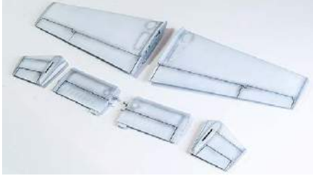
20 Die Tragflächen mit glänzendem Weiß (Alclad II „Glossy white Primer“) sind für die folgende Alufarbe poliert
