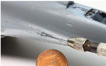
6 Das krude Kanonenrohr besser ersetzen? Einfach aufbohren geht hier deutlich schneller
