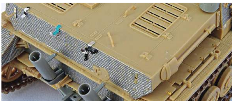
11 Die späte Abdeckung des Kühlwassereinlasses, Ersatzkettenglieder-Halterungen und geänderte Halterung für das Schleppseil
