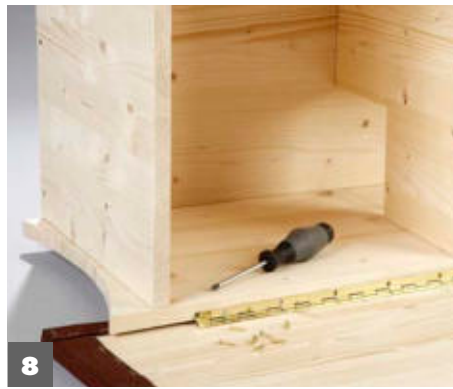
8 Den Korpus mit Klavierband an der Dachplatte montieren. Seitlich jeweils 50 mm Überstand lassen. Zum Einrasten der ...
