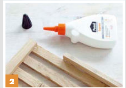
2 Oben und unten auf die langen Hölzer zwei Hölzchen (l=13 cm) hochkant und eines oben auf die Leiste kleben.
