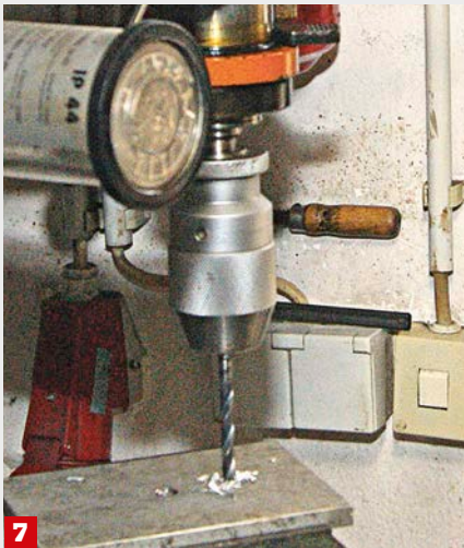
7 Peter bohrt das alte Durchgangsgewindeloch für die nächstgrößere Schraubengröße auf
