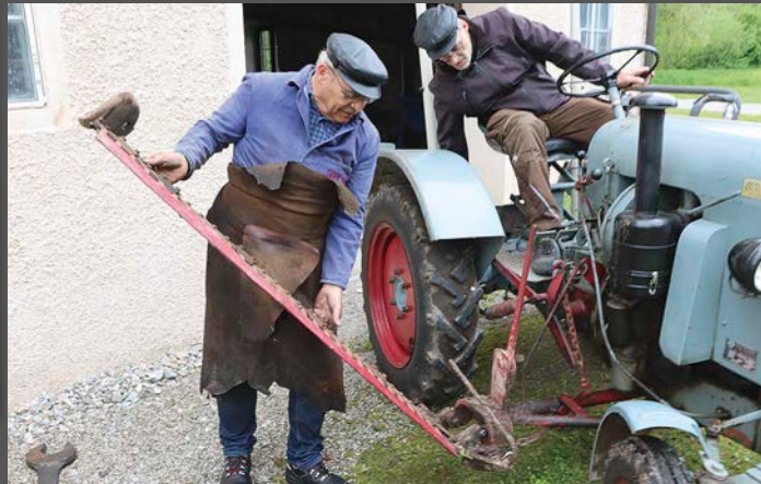
Fix und fertig mit neuen Klingen versehen! Jetzt wird das Mähmesser in den Messerbalken des Fingerschneidwerks eingebaut
