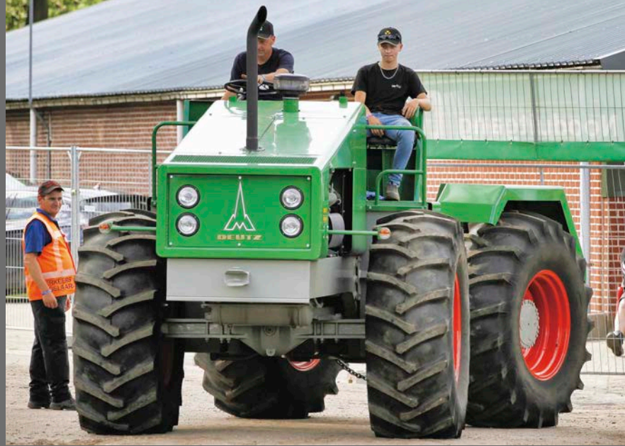
Summa cum laude: Deutz D 16006, hier die spätere Variante mit der schrägen Motorhaube. Die 160-PS-Knicklenker wurden 1969/1970 gebaut und brachten es auf 37 Exemplare inklusive zweier Prototypen
