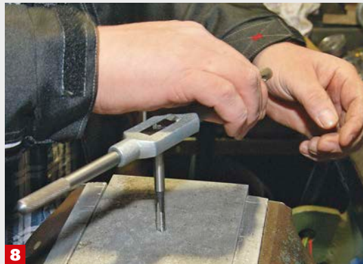
8 Mit dem Einschnittgewindebohrer wird in einem Zug das neue Gewinde in das Aluminium-Durchgangsgewindeloch geschnitten
