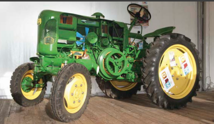
Spannendes Schnittmodell eines um 1960 gebauten John Deere-Lanz mit Zweitakt-Mitteldruckmotor
