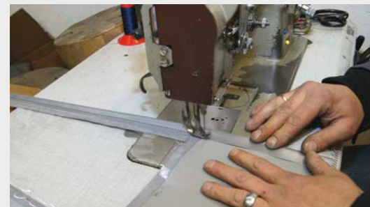
3 Um eine gerade Naht hinzukriegen, sind eine ruhige Hand und ein gutes Auge nötig
