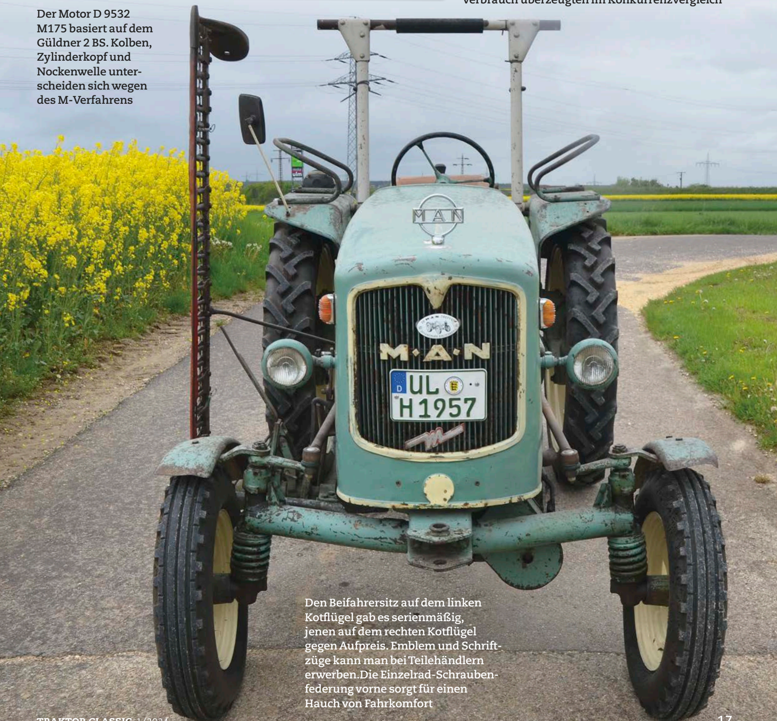
Das M-Verfahren kam ab September 1955 in allen MAN-Schleppern zum Zug. Laufruhe und Verbrauch uberzeugten im Konkurrenzvergleich
