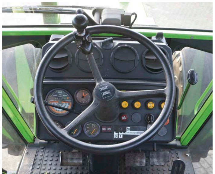
Die vier Luftausströmer im Armaturenbrett sind charakteristisch für den DX. Unterhalb der Lenksäule gibt es einen Hinweis auf die Getriebeabstufung
