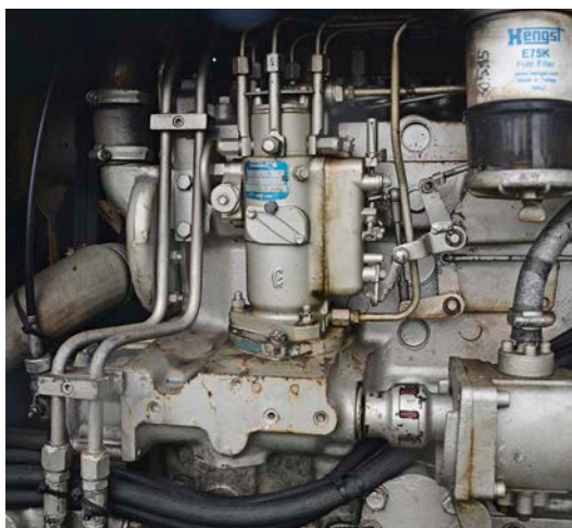
Millionending: Perkins-Sechszylinder mit senkrecht stehender Verteilereinspritzpumpe
