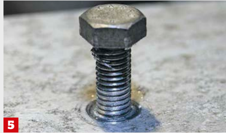
5 Speziell bei der Materialpaarung Aluminium/Stahl gibt oft das Aluminium-Gewinde auf
