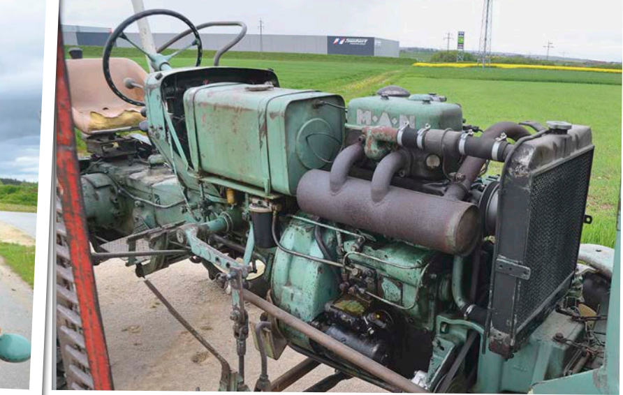
Der Motor D 9532 M175 basiert auf dem Guldner 2 BS. Kolben, Zylinderkopf und Nockenwelle unterscheiden sich wegen des M-Verfahrens
