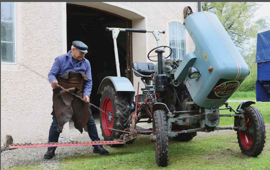
„Das für Gras- und Getreideschnitt gleichermaßen geeignete Mittelschneidwerk hat sich durchgesetzt, da das Tiefschnittschneidwerk für den Getreideschnitt ungeeignet sowie sehr empfindlich war und man besonders den Kleinbauern nicht den Kauf zwei verschiedener Schneidwerke zumuten wollte.“
