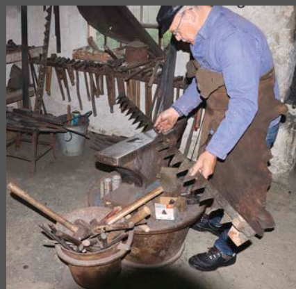
„Ich kontrolliere das Mähmesser auf Schäden und darauf, welche Messerklingen getauscht werden müssen.“
