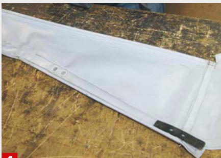
4 Erster Schritt beim Einnähen eines Fensters: Heinz zeichnet die Konturen des Fensters auf den Verdeckstoff auf
