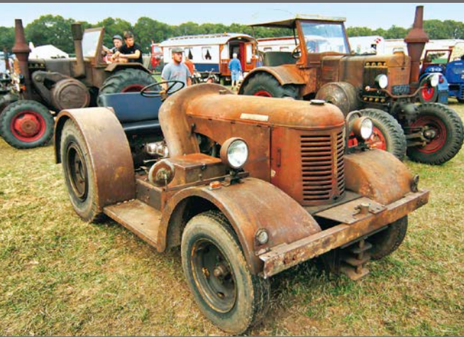
David-Brown-Flugzeugschlepper VIG 1/462 Mk2 von 1940, fünf Tonnen schwer und angetrieben von einem Otto-Motor
