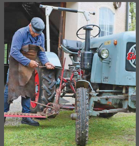
„Da es Fingerschneidwerke als Hochschnitt- (3 Zoll Fingerabstand), Tiefschnitt- (1,5 Zoll Fingerabstand) und Mittelschnitt-Schneidwerk (2 Zoll Fingerabstand) gab, muss ich darauf achten, worum es sich handelt, um den Hub der Messerstange richtig einzustellen.“
