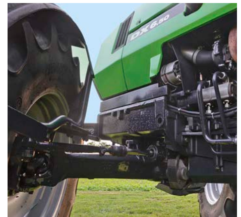
Bei 40 km/h damals Pflicht: zusätzliche Scheibenbremse auf der Antriebswelle zur Vorderachse
