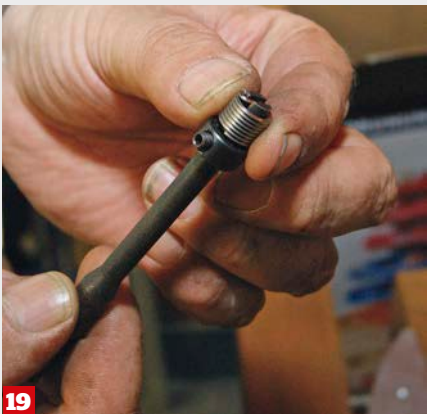
16 Die Fase darf nicht zu groß gesetzt werden, da sonst „Auflagefleisch“ für den Schraubenkopf fehlt
