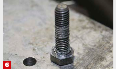
6 Beim Herausdrehen ist das Gewinde vollständig aus dem Aluminium-Durchgangsgewinde herausgekommen
