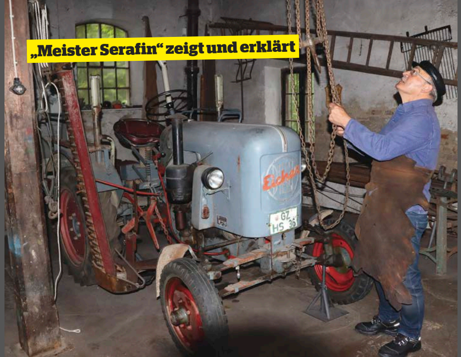
„Beim Kundendienst wurde der Schlepper immer vorne angehoben, um die Vorderachse zu entlasten. Dadurch kam das Fett beim Abschmieren an die richtige Stelle. Mittelachsbolzen, Achsschenkel und Drucklager mussten gut gefettet werden, um leichtes und sicheres Lenken zu ermöglichen.“
