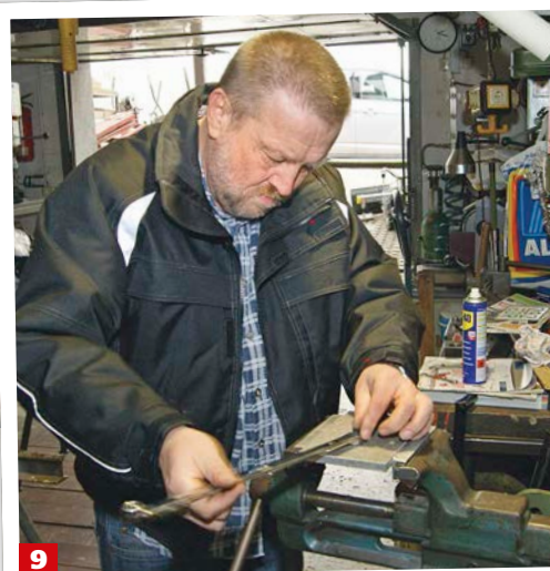
9 Peter testet zuerst das Gewinde, bevor die Distanzplatte wieder verbaut wird. Die eingedrehte Schraube muss plan aufsitzen
