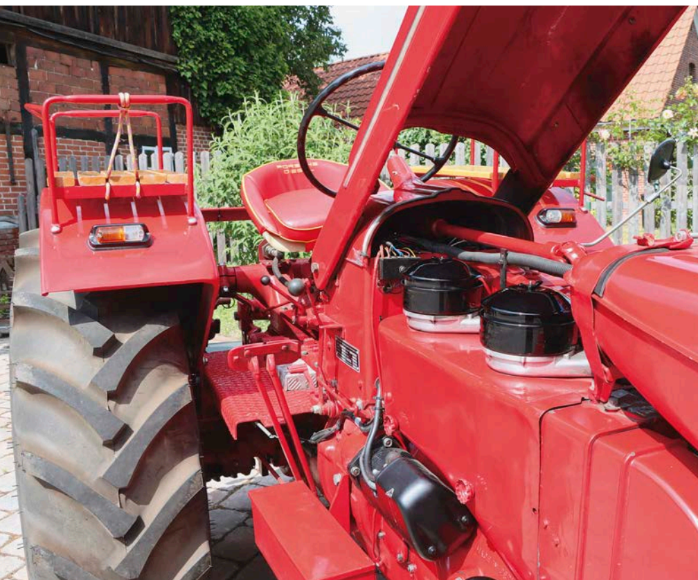
Unten : Blick auf den Vierzylinder-Diesel aus dem Hause Porsche-Diesel, der bereits den Allgaier A 144 (1953 bis 1955) antrieb
