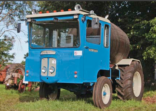
Kurios: selbstfahrende Feldspritze der heute noch erfolgreichen belgischen Landtechnikmarke Delvano, basierend auf einem Fordson Super Dexta von 1963!
