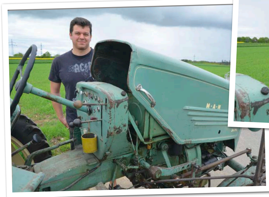
Die einteilige Motorhaube ist auch fürs Tanken zu öffnen. Der Kraftstoffbehälter fasst 26 Liter. Links daneben wohnt die Batterie
