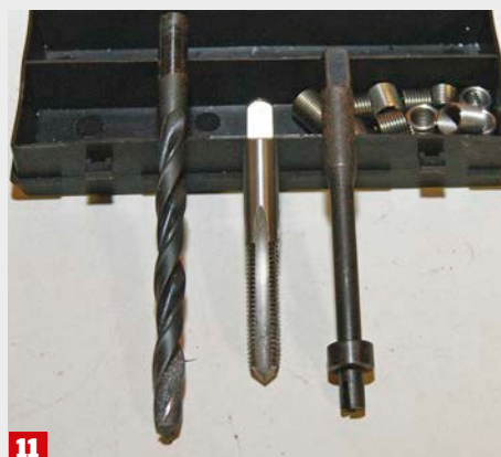
11 In den Gewindereparatur-Sets ist alles enthalten, um ein defektes Gewinde reparieren zu können
