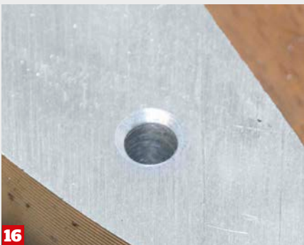
13 Mit dem im Reparatursatz beiliegenden Kernlochbohrer muss das alte Gewinde aus dem Gewindeloch gebohrt werden
