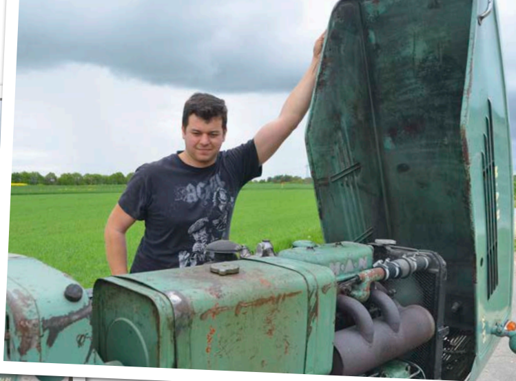
Die einteilige Motorhaube ist auch fürs Tanken zu öffnen. Der Kraftstoffbehälter fasst 26 Liter. Links daneben wohnt die Batterie
