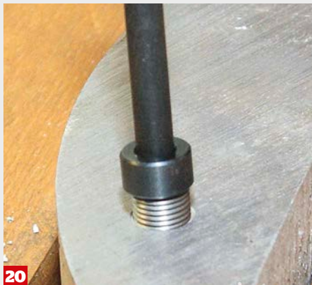
17 In einem Zug schneidet Peter mit dem speziellen Einschnittgewindebohrer das Gewinde für den Einsatz
