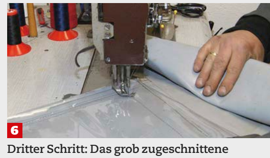
6 Dritter Schritt: Das grob zugeschnittene Folienglas wird von der Rückseite faltenfrei entlang der aufgezeichneten Kontur auf das Verdeck genäht
