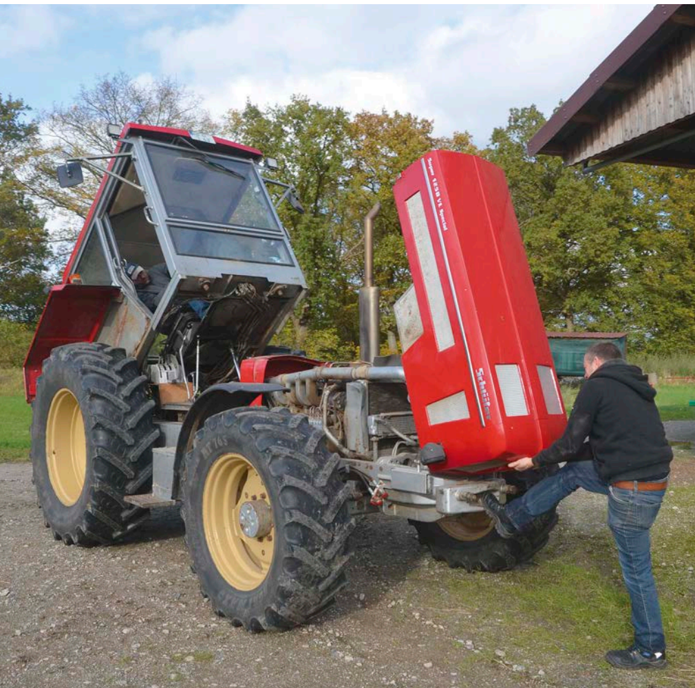
Merten demonstriert die Super-Service-Technik: Die Kabine lässt sich hydraulisch kippen, die Motorhaube mit Hilfe menschlichen Gegengewichtes öffnen
