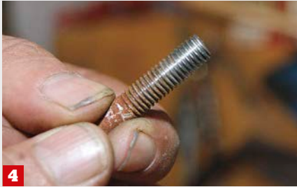
4 Das Gewinde der nachbearbeiteten Schraube ist wieder voll hergestellt und kann bedenkenlos eingedreht werden
