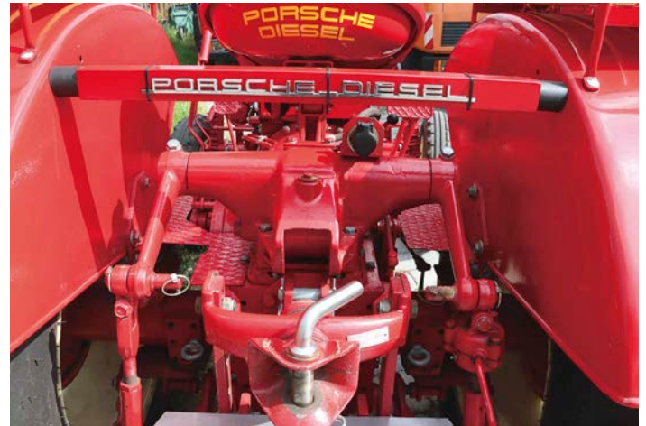
Oben: Dieser P 144 ist mit dem hydraulischen Kraftheber aus eigener Fertigung ausgestattet, den es auch für das Flaggschiff P 144 nur als Sonderausstattung gab
