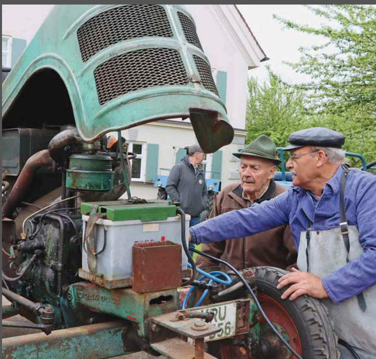
Dass sich der Kramer KL 11 von Rosa Wagner trotz Überbrückungshilfe nicht starten ließ, führte Robert auf eine defekte Glühkerze oder den altersschwachen Kabelbaum zurück
