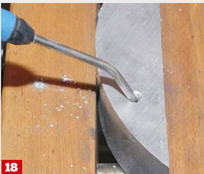
15 Hier wird am Rand des Bohrloches eine Fase gesetzt. Das erleichtert das Setzen des Gewindeeinsatzes
