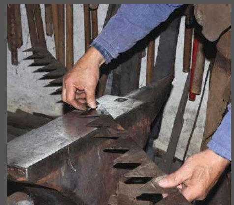
„Die Messerklingen werden mit 5,3-Millimeter-Senknieten auf den Messerrücken aufgenietet.“
