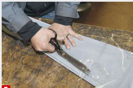
5 Zweiter Schritt: Das Folienglas wird grob zurechtgeschritten
