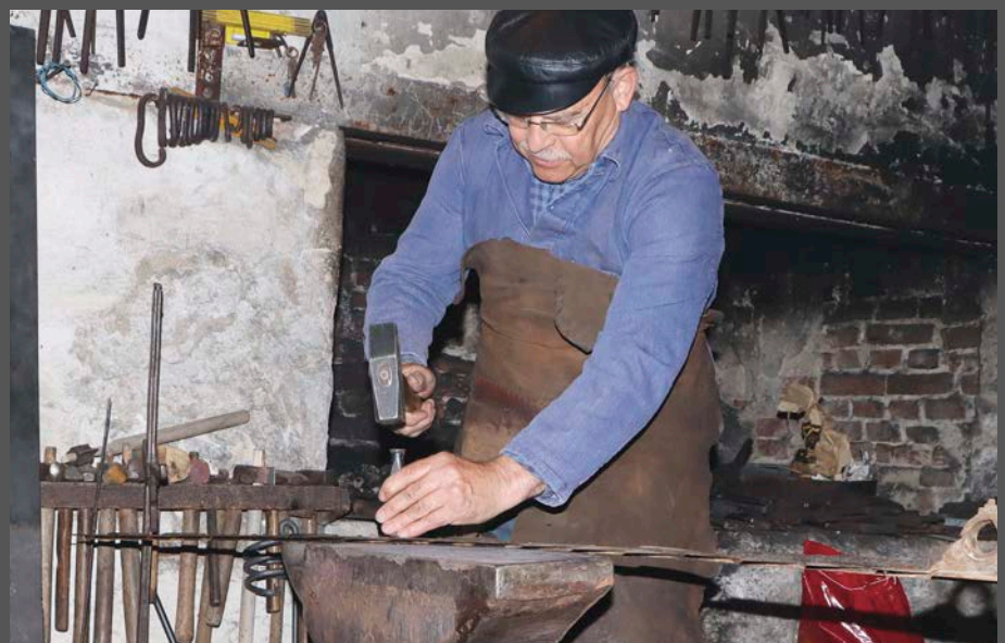
„Hier tausche ich die Messerklingen mit Hilfe von Nietenzieher und Kopfmacher aus.“
